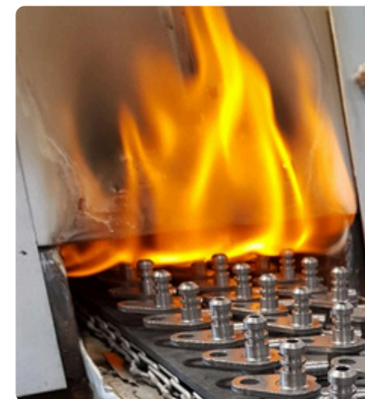
Propan som processgas och avfacklingsgas - skyddsgas i en av våra processer.
