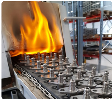
Till vänster: avfackling av vätgas i bandugnen, till höger nitrerugn där gaserna används i processer där de sönderfaller och skapar en kontrollerad atmosfär inuti ugnen.
