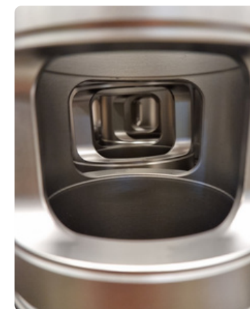
Gods efter lågtrycksuppkolning (LPC), ett miljövänligare alternativ till sätthårdning.
