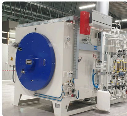
Till vänster: avfackling av vätgas i bandugnen, till höger nitrerugn där gaserna används i processer där de sönderfaller och skapar en kontrollerad atmosfär inuti ugnen.
