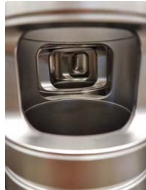
Gods efter lågtrycksuppkolning (LPC), ett miljövänligare alternativ till sätthårdning.
